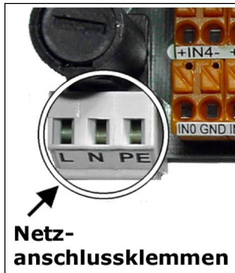
Das Gerät besitzt eine Feinsicherung 220V/0,1A Flink, die in einem Sicherungshalter hinter der Netzanschlußklemme zu finden ist.
