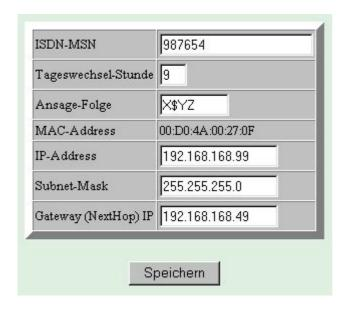
Die **ISDN-MSN** des Gerätes ist die Rufnummer (Multiple Subscriber Number) der pt-250 für den ISDN Anschluß. In Deutschland wird die Nummer ohne Vorwahl eingegeben. An Telefonanlagen kann dies z.B. die Durchwahl der Nebenstelle des ISDN-S0 Busses sein.
