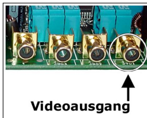
An den Monitorausgang der pt-210 kann ein PAL-Signal kompatibler Farb- oder Schwarz/Weiß-Monitor bzw. Farbfernseher angeschlossen werden. Der Monitor kann das aktuell ausgewählte Videosignal eines Einganges wiedergeben oder, als Bildempfänger, die empfangenen Bilder wiedergeben.
