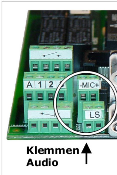
Der Eingang wird in den Konfigurationsdaten als "externes Mikrofon" oder "Mikrofon 2" bezeichnet, da bereits ein Mikrofon im Gerät eingebaut ist.
