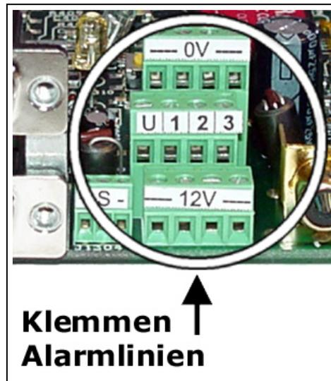
Die pt-210 besitzt drei potentialfreie Eingänge für den Anschluß von Bewegungsmeldern, Türkontakten oder Tastern. Sowie einen potentialfreien Eingang für einen externen Scharf/Unscharf-Schalter. Wird die Scharf/Unscharf-Klemme mit der 0V Klemme verbunden, dann wird das Gerät "Unscharf" geschaltet, so daß ein Alarm an einer Eingangsklemme keinen Alarm mehr auslöst.
