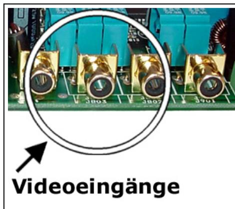
Zum Anschluß der Kameras an der pt-210 verwenden sie 75 $\Omega$  Coaxial-Kabel (z.B. RG59) mit Cinch-stecker. Verbinden sie den Schirm des Coax-Kabels nicht anderen Ein/Ausgängen des Gerätes, um die Signalqualität nicht zu beeinträchtigen!
