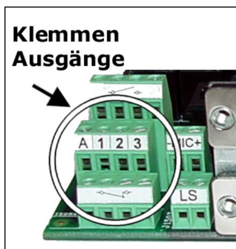
Die pt-210 besitzt drei universelle potentialfreie Relaisumschaltkontakte und einen potentialfreien Relaisumschaltkontakt, der im Alarmfall schaltet. Alle Kontakte sind für den Anschluß von Verbrauchern bis
