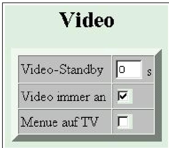
Geben Sie im **Video-Standby** Feld an, nach welcher Zeit, nach der letzten Videoübertragung der Video-Teil abgeschaltet werden soll. Dadurch wird die Wärmeentwicklung und die Stromaufnahme des Gerätes reduziert.
