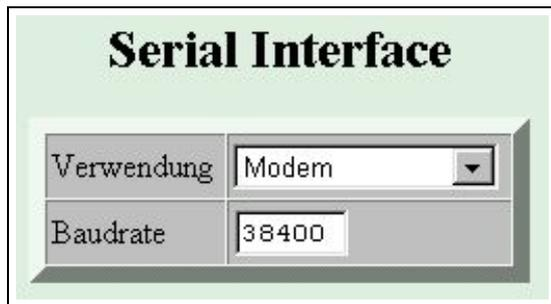
Die serielle Schnittstelle wird zum Anschluß eines (Fax-)Modems oder eines Peripherie-Steuergerätes verwendet. Stellen die unter **Verwendung** den Typ des angeschlossenen Gerätes ein.
