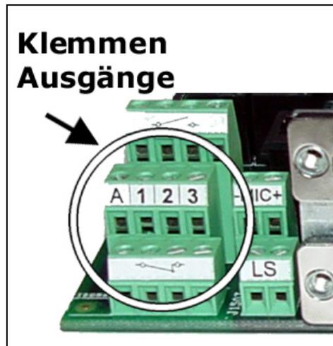
Die pt-205 besitzt drei universelle potentialfreie Relaisumschaltkontakte und einen potentialfreien Relaisumschaltkontakt, der im Alarmfall schaltet. Alle Kontakte sind für den Anschluß von Verbrauchern bis 4A/230VAC kurzzeitig und 1A/230V Dauerbetrieb ausgelegt.
