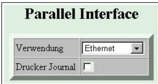
Die parallele Schnittstelle am DB25-Steckverbinder kann zum Anschluß verschiedener Peripheriegeräte verwendet werden. Stellen sie im Feld **Verwendung** ein, welchen Verwendungszweck sie der Schnittstelle zugeordnet haben. Durch Auswahl der Kurzkonfiguration wird eine automatische Erkennung der bekannten Peripherie-Optionen durchgeführt.
