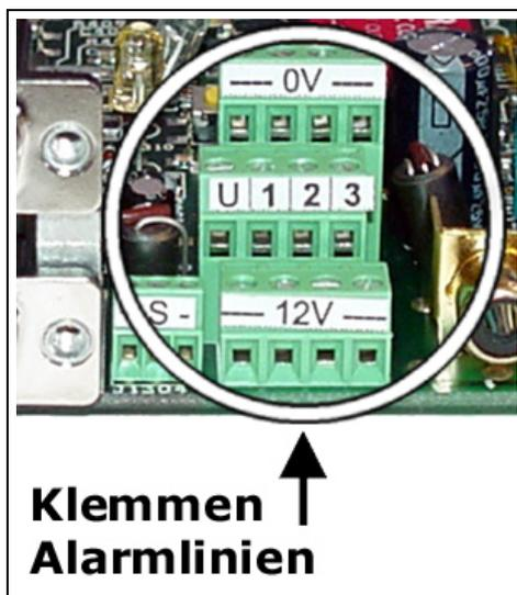
Die pt-205 besitzt drei potentialfreie Eingänge für den Anschluß von Bewegungsmeldern, Türkontakten oder Tastern. Sowie einen potentialfreien Eingang für einen externen Scharf/Unscharf-Schalter. Wird die Scharf/Unscharf-Klemme mit der 0V Klemme verbunden, dann wird das Gerät "Unscharf" geschaltet, so daß ein Alarm an einer Eingangsklemme keinen Alarm mehr auslöst.
