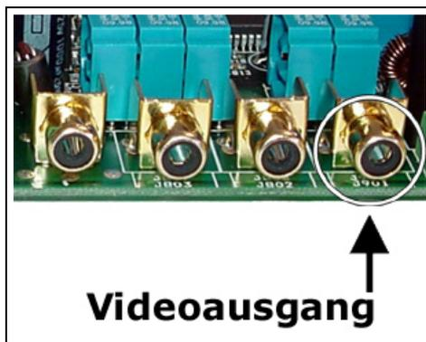
An den Monitorausgang der pt-205 kann ein PAL-Signal kompatibler Farb- oder Schwarz/Weiß-Monitor bzw. Farbfernseher angeschlossen werden. Der Monitor kann das aktuell ausgewählte Videosignal eines Einganges wiedergeben oder, als Bildempfänger, die empfangenen Bilder wiedergeben.
