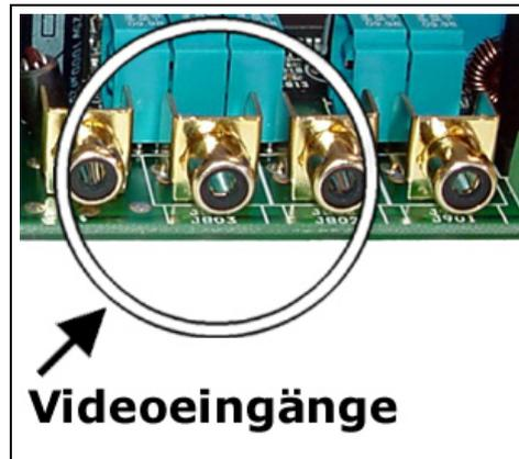
Zum Anschluß der Kameras an der pt-205 verwenden sie 75 $\Omega$  Coaxial-Kabel (z.B. RG59) mit Cinchstecker. Verbinden sie den Schirm des Coax-Kabels nicht anderen Ein/Ausgängen des Gerätes, um die Signalqualität nicht zu beeinträchtigen!
