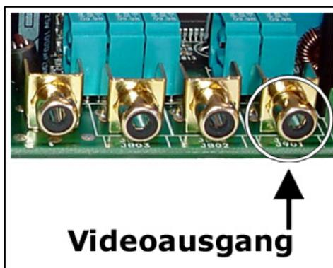
An den Monitorausgang der pt-200 kann ein PAL-Signal kompatibler Farb- oder Schwarz/Weiß-Monitor bzw. Farbfernseher angeschlossen werden. Der Monitor kann das aktuell ausgewählte Videosignal eines Einganges wiedergeben oder, als Bildempfänger, die empfangenen Bilder wiedergeben.
