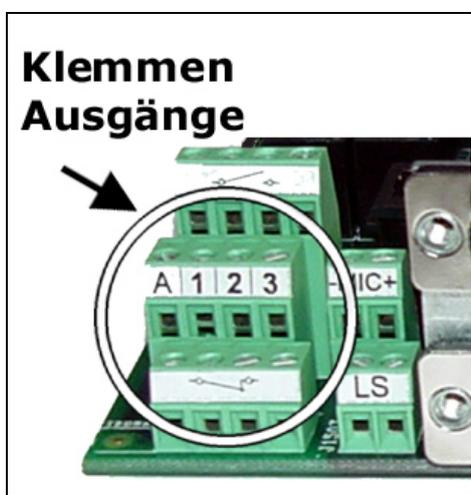
Die pt-200 besitzt drei universelle potentialfreie Relaisumschaltkontakte und einen potentialfreien Relaisumschaltkontakt, der im Alarmfall schaltet. Alle Kontakte sind für den Anschluß von Verbrauchern bis
