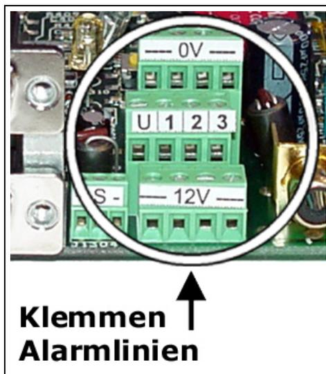
Die pt-200 besitzt drei potentialfreie Eingänge für den Anschluß von Bewegungsmeldern, Türkontakten oder Tastern. Sowie einen potentialfreien Eingang für einen externen Scharf/Unscharf-Schalter. Wird die Scharf/Unscharf-Klemme mit der 0V Klemme verbunden, dann wird das Gerät "Unscharf" geschaltet, so daß ein Alarm an einer Eingangsklemme keinen Alarm mehr auslöst.
