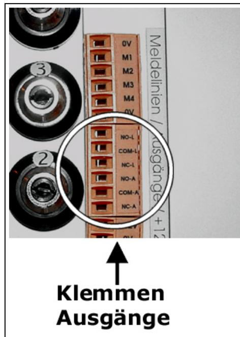
Die pt-100 besitzt einen universellen potentialfreien Relaisumschaltkontakt und einen potentialfreien Relaisumschaltkontakt, der im Alarmfall schaltet. Beide Kontakte sind für den Anschluß von Verbrauchern bis 6A/230VAC kurzzeitig und 2A/230V Dauerbetrieb ausgelegt.
