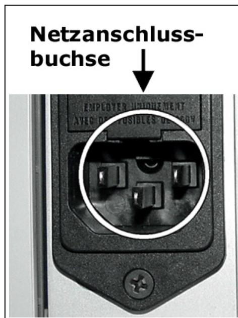
Die pt-100 benötigt zum Betrieb einen 230V Netzanschluß. Die maximale Leistungsaufnahme kann 25 Watt betragen, die typische Leistungsaufnahme liegt bei 10 Watt.
