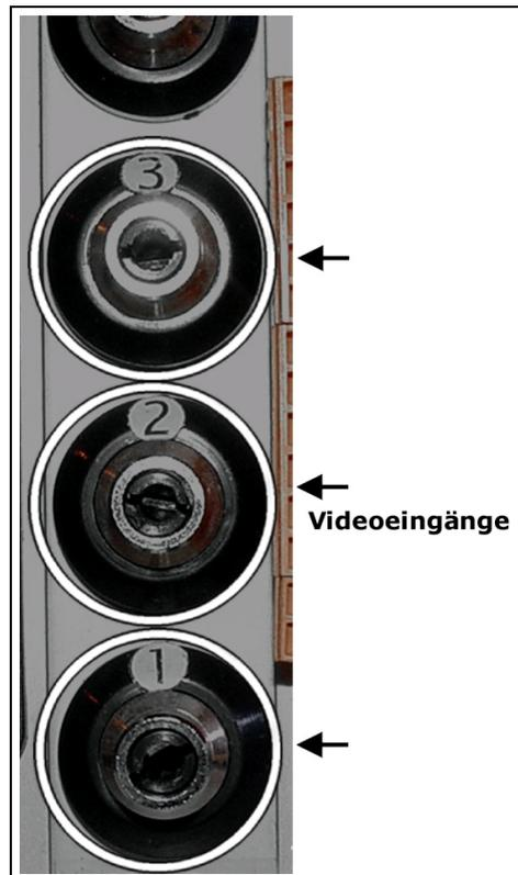
Zum Anschluß der Kameras an der pt-100 verwenden sie  $75\Omega$  Coaxial-Kabel (z.B. RG59) mit Cinchstecker. Verbinden sie den Schirm des Coax-Kabels nicht anderen Ein/Ausgängen des Gerätes, um die Signalqualität nicht zu beeinträchtigen!
