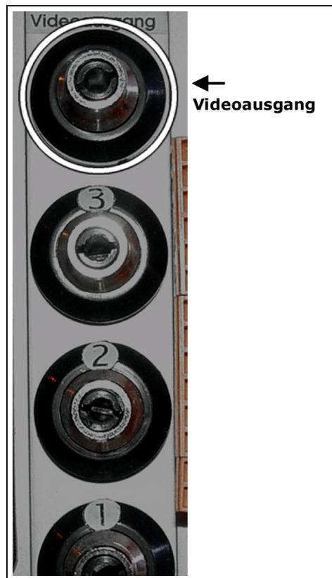
An den Monitorausgang der pt-100 kann ein PAL-Signal kompatibler Farb- oder Schwarz/Weiß-Monitor bzw. Farbfernseher angeschlossen werden. Der Monitor kann das aktuell ausgewählte Videosignal eines Einganges wiedergeben oder, als Bildempfänger, die empfangenen Bilder wiedergeben.
